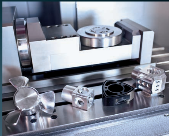
Dreh-, Schwenkeinheit mit typischen Werkstücken
