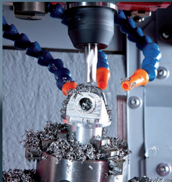
Dreh-, Schwenkeinheit im Einsatz
